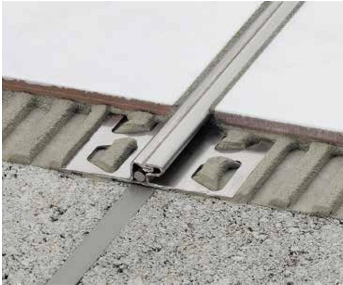
ennent même pour des revêtements exposés à des sollicitations intenses tels que des zones de circulation de véhicules ou des revêtements soumis à un nettoyage mécanisé. Les mouvements de la structure du revêtement sont absorbés par le coulisement des pièces dans l'assemblage à rainure et languette. Ce profilé sans entretien présente une surface visible de 12 mm et se distingue par une robustesse et une longévité extrêmes du fait de sa nature."
