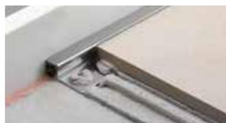
Schlüter-DILEX-KSA est un profilé de raccordement avec protection des arêtes, comportant une aile de fixation latérale en aluminium ou en acier inoxydable reliée à une zone de dilatation interchangeable en matériau synthétique souple. Il sert au raccordement de revêtements au niveau d'éléments fixes tels que des fenêtres.
