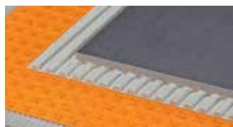
Schlüter-DITRA est une membrane en polypropylène avec des creux carrés contre-dépouillés au design Easyfill, pourvue au verso d'un voile non-tissé de renfort. Elle s'utilise comme support universel pour des revêtements carrelés en tant que couche de désolidarisation, étanchéité composite et égalisation de la pression de vapeur.
