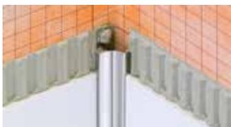
Schlüter-DILEX-HKU est un profilé à gorge creuse entièrement en acier inoxydable, pour la réalisation d'angles rentrants muraux et de raccords sol/mur soumis à des contraintes d'hygiène élevées. Du fait de l'aile de fixation interne, le profilé peut être utilisé pour des épaisseurs de revêtements différentes.
