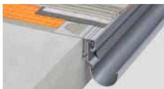
Schlüter-BARA-RTK est un profilé de rive pour balcons avec rejetau, destiné à être posé sur une forme de pente. Le profilé a un dispositif d'accueil pour la fixation du système de gouttière Schlüter-BARIN. La réservation au-dessus du rejetau permet de poser un profilé de finition Schlüter-JOLLY qui dissimulera le chant du carreau. Les carreaux peuvent aussi être posés avec un débord.
