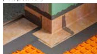
Schlüter-KERDI-CID sont des sets d'étanchéité permettant une interruption capillaire au niveau de passages de portes selon la norme DIN 18534. Il existe un set pour le sens d'ouverture de la porte vers l'intérieur et un autre pour le sens d'ouverture de la porte vers l'extérieur. Ils comprennent un profilé Schlüter-SCHIENE-E avec bande d'étanchéité KERDI-KEBA intégrée, ainsi que les angles KERDI-KERECK correspondants.
