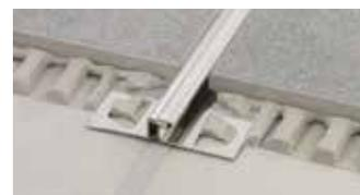
Schlüter-DILEX-EDP est un profilé de fractionnement pour pose collée, en acier inoxydable permettant d'absorber des mouvements horizontaux grâce à un assemblage languette et rainure.
