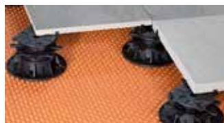
Schlüter-TROBA-LEVEL permet de poser des éléments de dalles autoporteurs de manière rapide, précise et sûre sur des balcons et des terrasses. Un nombre réduit de composants différents, combinables entre eux, permet une mise à niveau fiable du revêtement sur pratiquement tous les pourcentages de pentes et toutes les configurations de chantiers. Et ce, avec des hauteurs de structure à partir de 3 mm !
