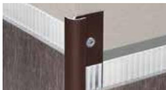
Schlüter-VINPRO-RO est un profilé de finition et de protection de chants de revêtements souples (p. ex. lames ou dalles LVT, revêtements design), conçu pour la réalisation d'angles sortants de murs. Le profilé recouvre ainsi les revêtements adjacents, empêchant une dégradation des chants due à des contraintes mécaniques.
