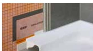
Schlüter-KERDI-TS est un set permettant de garantir un raccord étanche entre des éléments fixes (baignoires et receveurs de douche, selon DIN 18534-1) et le système d'étanchéité Schlüter-KERDI. Il comprend une bande d'étanchéité en polyéthylène, revêtu de non-tissé sur les deux faces, des bandes d'isolation phonique autocollantes, la colle de montage Schlüter-KERDI-FIX, des chiffons de nettoyage ainsi que d'angle(s) de montage.
