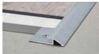
Schlüter-VINPRO-U est un profilé de transition entre un revêtement souple (p. ex. lames ou dalles décorées LVT) et un revêtement adjacent d'épaisseur inférieure. La surface inclinée facilite le passage d'un revêtement à l'autre sans butée. Le profilé assure également une protection fiable du chant du revêtement qui y est inséré.
