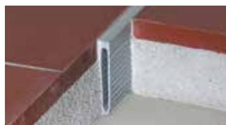
Schlüter-DILEX-MOP est un profilé de fractionnement conçu pour la réalisation de joints de fractionnement en pose scellée ou pour être introduit dans des joints sciés. Il est composé de parois latérales crantées, stables, en PVC dur recyclé et d'une zone souple en PVC gris.
