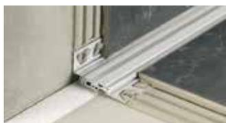
Schlüter-DILEX-BTO est un profilé couvre-joint de fractionnement en aluminium pour les transitions sol/mur. La liaison articulée latérale de la partie médiane emboîtée permet d'absorber des mouvements tridimensionnels.
