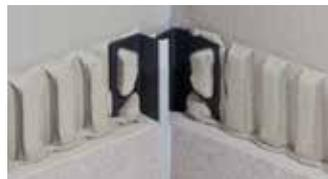
Schlüter-DILEX-EKE est un profilé d'angle souple monobloc en matériau synthétique dur/souple pour angles muraux rentrants ou pour la liaison sol/mur. Le profilé dispose d'une espace disponible pour intégrer le carrelage et peut être posé sur des supports non-flottants.
