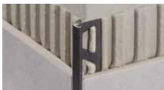
Schlüter-JOLLY est un profilé décoratif en aluminium coloré/structuré, en aluminium anodisé ou en PVC coloré pour angles muraux sortants, plinthes et bordures. Son aile de finition à 90° protège les carreaux des agressions mécaniques. Les espaceurs permettent de prédéfinir les joints entre carreaux et profilé. Les angles avec aide pour raccords garantissent une finition propre et décorative (sauf PVC).
