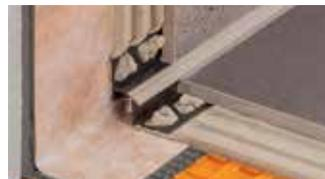
Schlüter-DILEX-EK est un profilé de joint périphérique flexible et durable en matériau synthétique dur/souple muni d'un assemblage à languette et rainure et un espace disponible pour intégrer le carrelage. Il permet de réaliser des joints de bordure durables, souples et sans entretien au niveau des liaisons sol/mur ou sol/plinthe.
