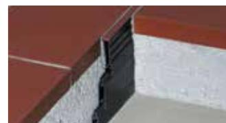
Schlüter-DILEX-MP est un profilé de fractionnement pour pose scellée. Il est composé de parois latérales en PVC dur recyclé, découpées en queue d'aronde, et d'une zone de dilatation en CPE souple. La hauteur est réglée au moyen de rehausses.
