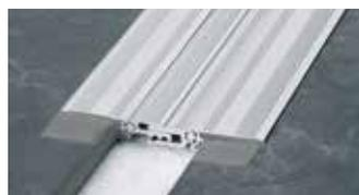
Schlüter-DILEX-BTS est un profilé couvre-joint de fractionnement en aluminium pour le montage ultérieur dans des revêtements déjà réalisés. La liaison articulée latérale de la partie médiane emboîtée permet d'absorber des mouvements tridimensionnels.
