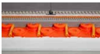
Schlüter-BEKOTEC-EN est la technique de construction sûre pour revêtement, pour la réalisation d'une chape ou d'une chape chauffante, sans fissuration et parfaitement fonctionnelle avec une épaisseur d'intégration faible, à partir de 52 mm (y compris 20 mm d'isolation). La chape BEKOTEC peut être utilisée non seulement pour des carreaux et des pierres naturelles, mais aussi en liaison avec d'autres revêtements.
