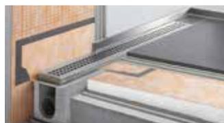
Schlüter-KERDI-LINE-H / -V / -F est un set complet pour douches à l'italienne avec évacuation horizontale ou verticale. Il peut s'utiliser indifféremment pour un montage au centre de la douche ou le long d'un mur. Le rebord du caniveau est doté d'une manchette Schlüter-KERDI collée en usine. Elle assure le raccordement du corps de caniveau avec l'étanchéité composite, tant au niveau du sol que des murs adjacents.
