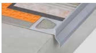
Schlüter-BARA-RKK est un profilé de rive en T avec rejetau court, destiné à être posé sur une chape en pente. Il est conçu pour une structure avec étanchéité composite Schlüter-DITRA. Le bord fermé du profilé permet de réaliser une finition soignée du revêtement carrelé.
