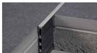
Schlüter-DILEX-EZ 70 est un profilé de fractionnement pour pose scellée. Il est composé de parois latérales en PVC dur découpées en queue d'aronde, et d'une zone de dilatation en PVC souple. La hauteur est réglée en découpant entre les éléments.
