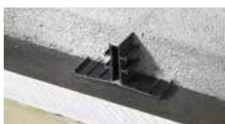
Schlüter-DILEX-EP est un profilé de fractionnement des chapes flottantes ou adhérentes. Les parties latérales sont en PVC dur recyclé, avec des zones de mouvement, inférieure et supérieure, en CPE gris souple.
