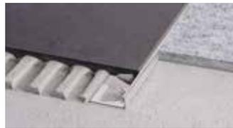
Schlüter-SCHIENE-ES est un profilé de finition en acier inoxydable pour revêtements carrelés ou en pierre naturelle. Il est doté d'un espaceur intégré qui permet de prédéfinir un joint constant entre carreau et profilé.
