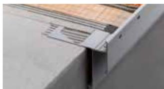
Schlüter-BARA-RAKE est un profilé de rive avec rejetau, destiné à être posé sur une forme de pente. Le profilé BARA-RAKE est particulièrement adapté à la pose en combinaison avec le drainage composite Schlüter-DITRA-DRAIN. Le bord perforé du profilé permet l'évacuation des eaux de drainage et une finition soignée du revêtement carrelé.
