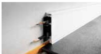
Schlüter-DESIGNBASE-CQ est un profilé en aluminium anodisé, alu. finition inox. anodisé ou coloré, de haute qualité, permettant de réaliser des habillages de plinthes décoratifs. Les agrafes intégrées du profilé-support en plastique réglable en hauteur permettent un montage masqué de câbles. Des sorties de câbles sont proposées dans les accessoires.
