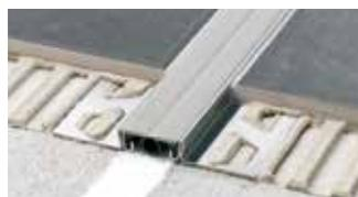
Schlüter-DILEX-KSBT est un profilé couvre-joint de dilatation en aluminium ou en acier inoxydable, avec une zone de déformation de 20 ou 30 mm de largeur en caoutchouc synthétique souple.
