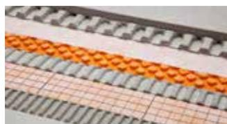
Schlüter-DITRA-DRAIN sont des nattes en polyéthylène indéformables avec une structure en plots unilatérale. Elles s'utilisent comme support universel pour des revêtements carrelés en tant que couche de désolidarisation et drainage composite à capillarité passive durablement efficace.
