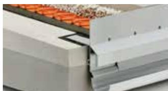
Schlüter-BARA-RKLT est un profilé de rive en équerre en aluminium coloré avec orifices d'évacuation de l'eau. Il convient pour des dalles de grand format posées au choix sur les lits de graviers/de concassé sans liant ou sur un système de plots. BARA-RKLT possède un dispositif d'accueil en forme de T pour la fixation du système de gouttière Schlüter-BARIN.
