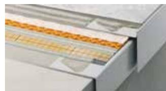
Schlüter-BARA-RT / -RTC est un profilé de rive en T, en aluminium anodisé coloré, pour la délimitation des surfaces de balcons et terrasses. L'aile de finition supérieure recouvre l'arête du revêtement et l'aile inférieure forme un rejetau et cache l'évacuation du drainage de surface TROBA.
