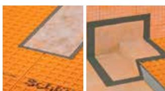
Schlüter-KERDI-KEBA/-KERS sont des étanchéités en polyéthylène dotées d'un non-tissé sur les deux faces. Les bandes d'étanchéité KERDI-KEBA conviennent pour l'étanchéité des liaisons entre les lés et les raccords sol/mur. KERDI-KERS sont des éléments préformés permettant de garantir une étanchéité parfaite des pièces d'angle de douches à l'italienne.
