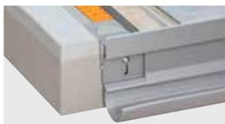
Schlüter-BARA-RTKEG est un profilé de rive avec rejetau, destiné à être posé sur une forme de pente. Le profilé a un dispositif pour la fixation du système de gouttière Schlüter-BARIN. Le profilé est adapté à la pose en combinaison avec la natte de désolidarisation Schlüter-DITRA. Le bord fermé du profilé permet de réaliser une finition soignée du revêtement carrelé.
