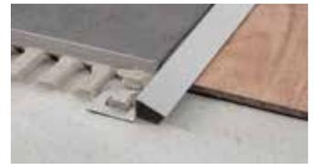
Schlüter-RENO-TK est un profilé de transition à recouvrement pouvant réaliser la liaison entre une moquette et un carrelage. Les bords des revêtements adjacents sont protégés efficacement.
