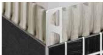
Schlüter-FINEC est un profilé de finition de haute qualité, en acier inoxydable, en aluminium coloré/structuré ou en aluminium anodisé, pour angles muraux sortants de revêtements céramique, mosaïques de verre ou de surfaces enduites spatulées. Le profilé de finition protège les revêtements des agressions mécaniques, tout en formant un angle étroit et élégant.
