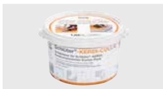
Schlüter-KERDI-COLL-L est une colle étanche bi-composant : une dispersion acrylique exempte de solvant et une poudre réactive à base de ciment. Elle permet le collage et l'étanchéité des systèmes Schlüter-KERDI et -DITRA/-DITRA-HEAT, ainsi que le collage des raccords de Schlüter-KERDI-KEBA sur les profilés de rive Schlüter-BARA.
