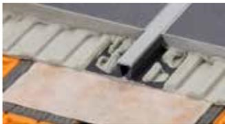
Schlüter-DILEX-BWB est un profilé de fractionnement pour pose collée avec des parties latérales en matière synthétique, recyclée, rigide. La partie supérieure en matière plastique souple présente une surface visible de 10 mm de largeur.
