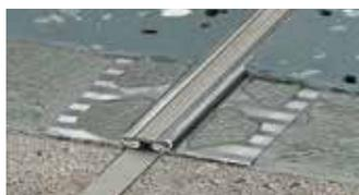
Schlüter-DILEX-EKSB est un profilé pour joint de fractionnement avec protection d'arête pour les revêtements de sol de faible épaisseur. Il se compose d'ailes de fixations latérales en acier inoxydable reliées par une zone de dilatation, non interchangeable, en plastique souple.
