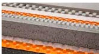
Schlüter-TROBA-PLUS est une natte de drainage à capillarité passive assurant une évacuation durable et efficace des infiltrations d'eau. Les plots coniques très rapprochés supportent des charges élevées et sont recouverts d'un non-tissé perméable. Ces plots assurent le soutien du revêtement sur toute sa surface et ménagent ainsi un espace de drainage continu.
