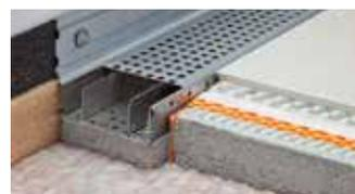
Schlüter-TROBA-LINE-TL est un caniveau de drainage en acier inoxydable qui peut être monté sur des balcons et terrasses en l'absence de hauteur suffisante pour un relevé d'étanchéité. On évitera ainsi l'eau de refoulement devant une porte. Peut aussi s'utiliser comme caniveau de drainage de surface.
