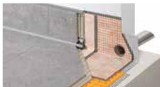
Schlüter-KERDI-DRAIN-SP-E est une gargoille en acier inoxydable pour l'évacuation de l'eau des surfaces de balcons et terrasses entourés d'un mur ou d'un muret. La manchette Schlüter-KERDI en tant que raccord d'étanchéité se colle sur la platine, garantissant ainsi une liaison simple et sûre des étanchéités composites.
