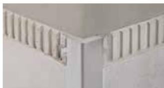
Schlüter-ECK-E est un profilé d'angle sortant en acier inoxydable pour revêtements carrelés. Il offre une très bonne protection des arêtes soumises à de fortes sollicitations. Les ailes de fixations perforées seront noyées lors de la pose du carrelage dans le mortier-colle.
