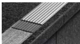
Schlüter-TREP-EFK est un profilé pour escalier en acier inoxydable, présentant un relief antidérapant spécial, permettant un agencement sûr et esthétique des nez de marche. Il peut se placer au moyen de colle de montage dans des évidements prévus à cet effet, ou ultérieurement sur des marches.
