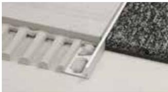
Schlüter-SCHIENE est un profilé conçu pour la protection et la décoration des arêtes des revêtements carrelés. Ce profilé peut également être utilisé pour d'autres revêtements ou applications. Un espaceur permet de prédéfinir le joint entre carreau et profilé. Le profilé Schlüter-SCHIENE-E ne possède pas d'espaceur.
