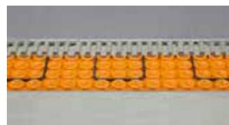
Schlüter-DITRA-HEAT est une natte en polypropylène présentant une structure à plots en queue d'aronde et dotée de dos d'un support non-tissé. Elle sert de support universel pour revêtements carrelés et assure les fonctions de désolidarisation, d'étanchéité, d'égalisation de la pression de vapeur, et peut recevoir des câbles de chauffage.
