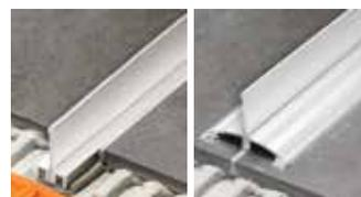
Schlüter-SHOWERPROFILE-WS/-WSK sont des profilés en aluminium anodisé en deux parties pour la protection anti-débordement dans des douches à l'italienne. Le profilé-support pour SHOWERPROFILE-WSK sera collé ultérieurement sur des revêtements existants. Le profilé-support pour SHOWERPROFILE-WS sera noyé dans le lit de mortier-colle pendant la pose des carreaux. Les deux variantes conviennent à des fauteuils roulants.
