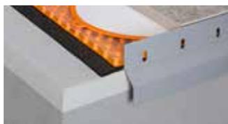
Schlüter-BARA-RKL est un profilé de rive en équerre en aluminium coloré avec orifices d'évacuation de l'eau. Il convient pour des dalles de grand format posées au choix sur des lits de graviers/de concassé sans liant ou sur un système de plots.
