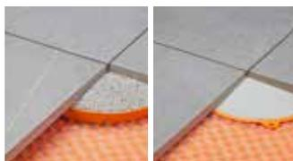
Schlüter-TROBA-STELZ-MR sont des disques de coffrage en polyéthylène qui facilitent la pose des dalles de grand format sur des balcons et terrasses. Ces disques de 25 mm de haut sont posés aux points de jonction des dalles, et remplis de mortier.
