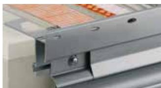
Schlüter-BARA-RTKE est un profilé de rive avec rejetau, destiné à être posé sur une forme de pente. Le profilé a un dispositif pour la fixation du système de gouttière Schlüter-BARIN. Le profilé BARA-RTKE est particulièrement adapté à la pose en combinaison avec le drainage composite Schlüter-DITRA-DRAIN. Le bord perforé du profilé permet l'évacuation des eaux de drainage et une finition soignée du revêtement carrelé.
