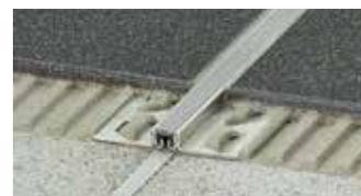
Schlüter-DILEX-KS est un profilé pour joint de fractionnement pour pose collée avec protection des arêtes de carrelage, comportant des ailes de fixation latérales en aluminium ou en acier inoxydable reliées entre elles par une zone pouvant se déformer, interchangeable en matériau synthétique souple.
