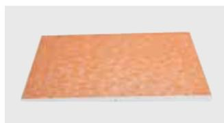
Schlüter-KERDI-SHOWER-LT/-LTS sont des receveurs avec pente en polystyrène résistant à la pression, recouverts d'une étanchéité Schlüter-KERDI collée en usine. Ils permettent la réalisation d'une pente adaptée en direction du caniveau Schlüter-KERDI-LINE dans les douches à l'italienne. Les panneaux peuvent être aisément redécoupés à l'aide d'un cutter grâce aux rainures prédéfinies.
