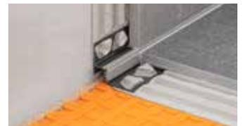
Schlüter-DILEX-RF est un profilé en deux parties en matériau synthétique dur/souple avec assemblage à rainure et languette pour des joints de bordure durablement souples au niveau des liaisons sol/mur ou au niveau des plinthes.
