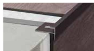
Schlüter-VINPRO-STEP est un profilé de finition et de protection des chants pour revêtements souples (p. ex. lames ou dalles décorées LVT, revêtements design) dans les escaliers. Le profilé couvre la zone adjacente et sert ainsi de protection des arêtes.
