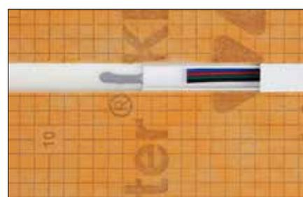
Le module de montage Schlüter-KERDI-BOARD-K disponible dans les épaisseurs 19 mm et 28 mm, et doté d'une rainure pour câble offre la possibilité de poser la goulotte de câble LT ZKK 2010. La goulotte de câble est équipée d'un couvercle séparé ; ce qui permet une pose de câbles depuis l'avant. Les câbles ne doivent pas être enfilés par le côté.
